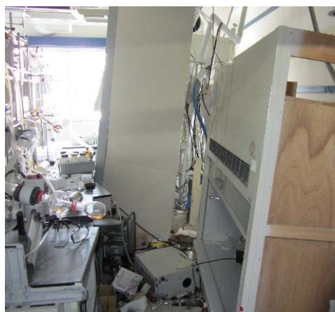
実験室内の状況:ドラフトが移動し、実験器具が床を埋める。
